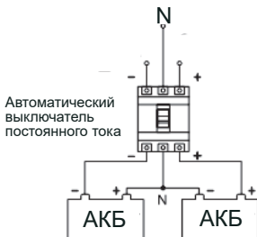
Рисунок 23 – Схема подключения АКБ
